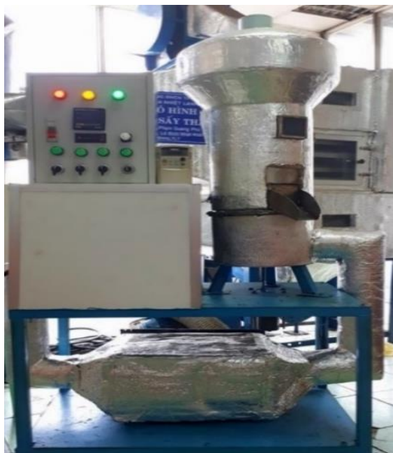
1- Tủ điện điều khiển; 2- Quạt cấp không khí; 3- Bộ gia nhiệt; 4- Bồn lắng; 5- Bồn sấy; 6- Bồn phân phối TNS
